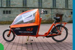
ULF ist ein einspuriges Lastenfahrrad der Marke Bakfiets ohne elektrische Unterstützung. In der Transportkiste befindet sich eine Sitzbank
