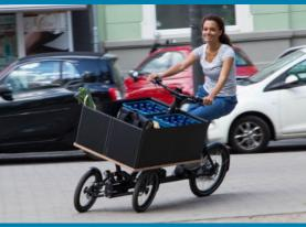
**Urmel** ist ein zweispuriges, elektrisch unterstütztes Cargobike der Marke Chike. Das Fahrwerk verfügt über eine innovative Neigetechnik. Eine große Transportkiste bietet viel Stauraum.
